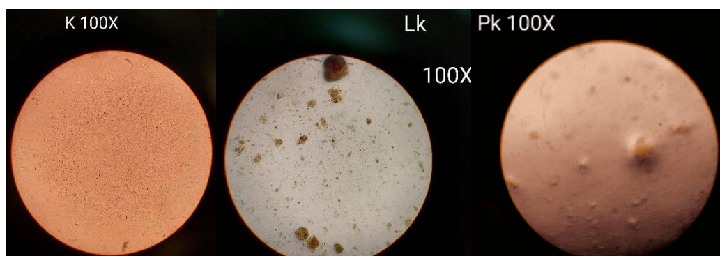
Slika 12. Mikroskopski pregleda filmova s kitozanom (K), kitozanom i listom konoplje (LK) te kitozanom i proteinom konoplje (PK) ( vlastita fotografija )
