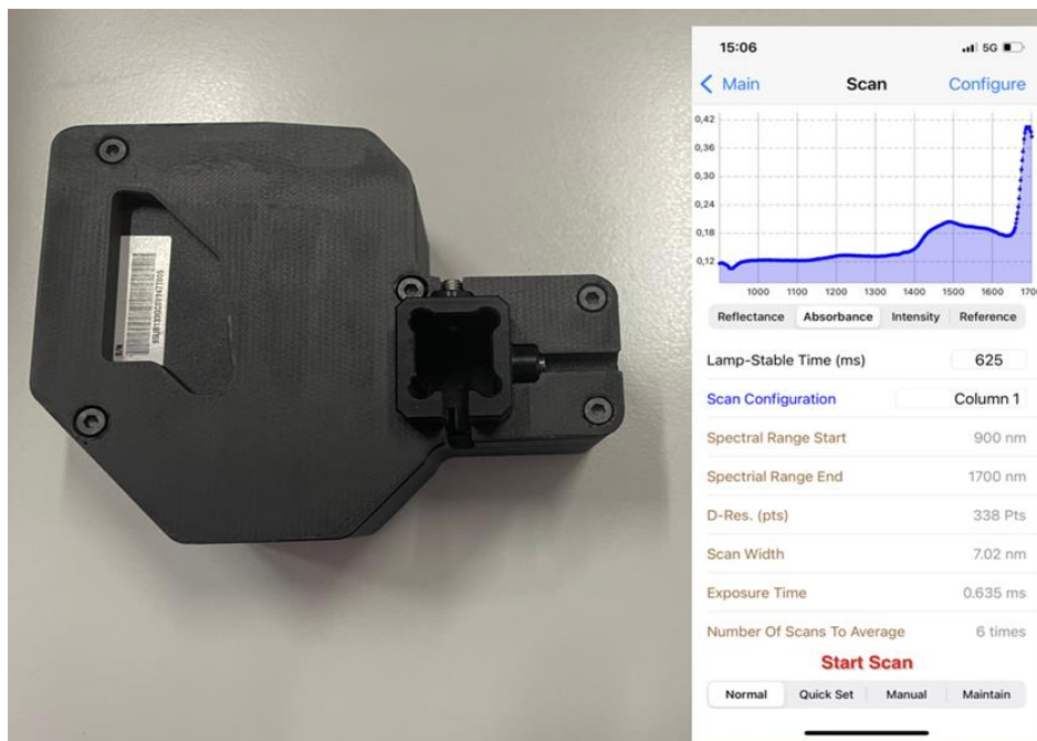
Slika 3. Prijenosni NIR instrument za tekuće uzorke (Ćorić, 2023)
