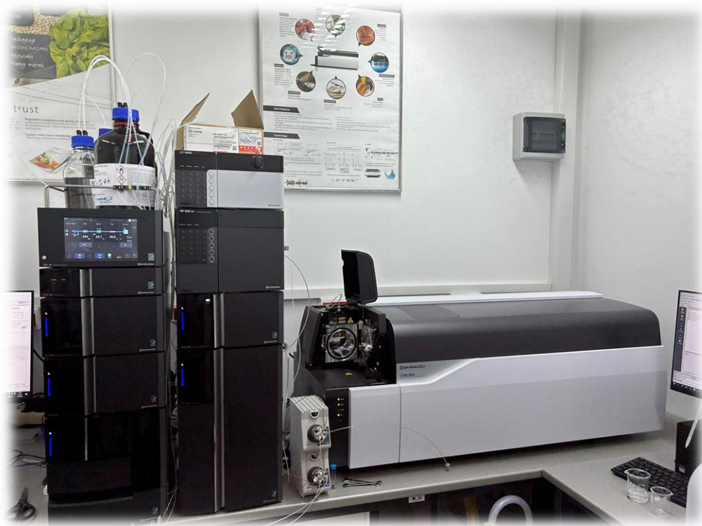
Slika 10. UHPLC uređaj Shimadzu Nexera u sprezi s masenim spektrometrom s trostrukim (QQQ) kvadрупolom Shimadzu LCMS 8045, Kyoto, Japan ( vlastita fotografija )
