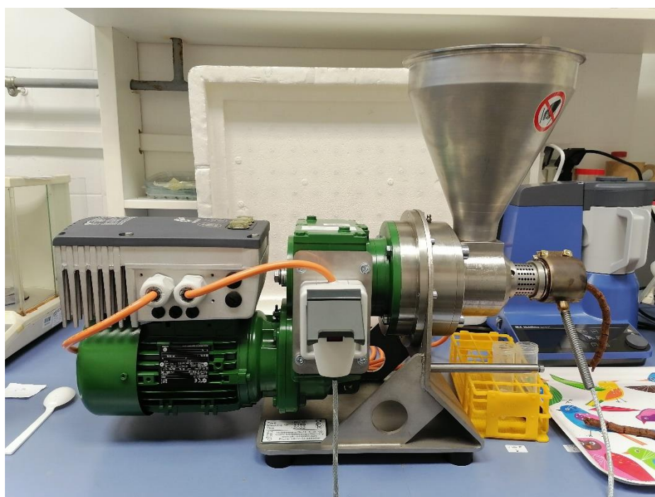
Slika 1. Laboratorijska pužna preša (vlastita fotografija)
