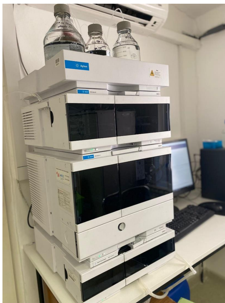
Slika 3. HPLC uređaj korišten za analizu polifenolnih spojeva ( vlastita fotografija )
