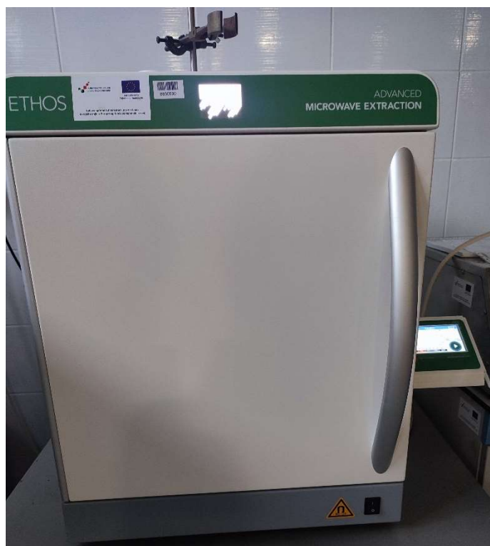
Slika 7. Mikrovalni reaktor (MILESTONE Ethos X) ( vlastita fotografija )
