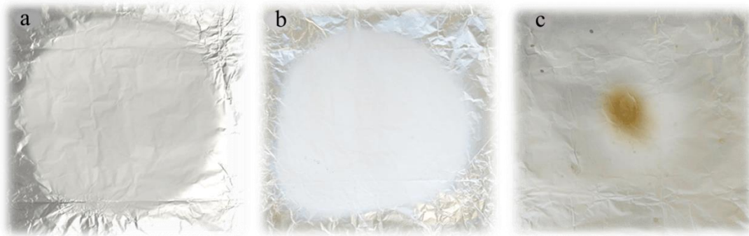
Slika 19. Vizualni izgled uspješno proizvedenih nanovlakana: a) 50PUL:50ZE i b) 80PUL:20KOL te c) neuspješan proizvod 100 ZE dobiven uslijed prelaska elektroispredanja u elektrosprejanje.
