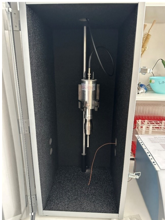
Slika 4. Kućište ultrazvuka visokog intenziteta korištenog za ekstrakciju ( vlastita fotografija )
