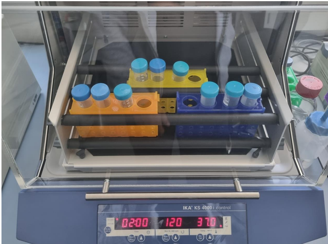
Slika 5. Simulacija uvjeta gastrointestinalnog trakta (vlastita fotografija)
