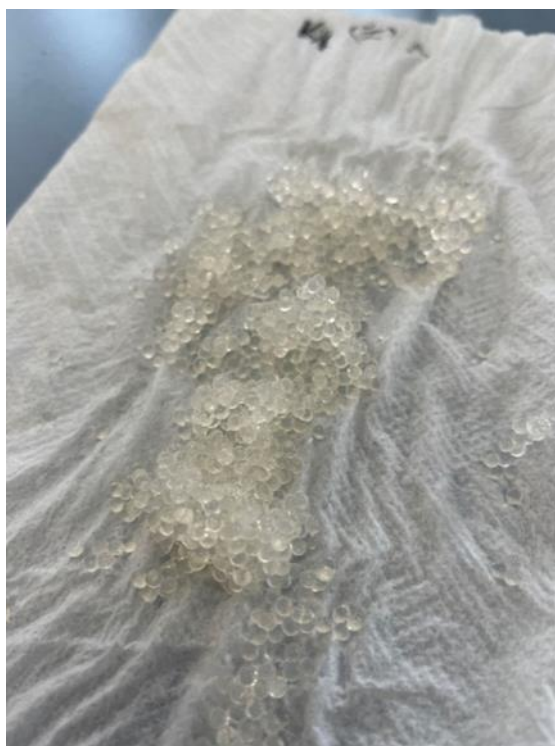
Slika 4. Sušenje mikrokapsula na zraku (vlastita fotografija)
