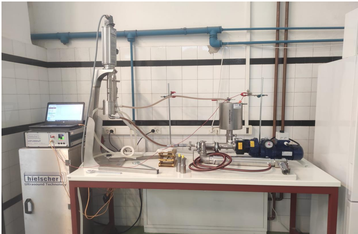
Slika 5. Aparatura za ekstrakciju potpomognutu ultrazvukom (vlastita fotografija)
