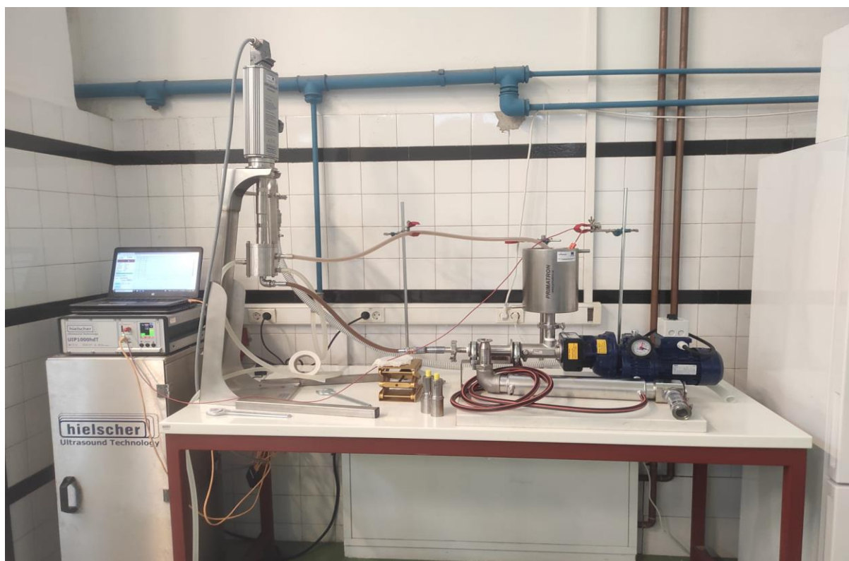
Slika 5. Aparatura za ekstrakciju potpomognutu ultrazvukom (vlastita fotografija)
