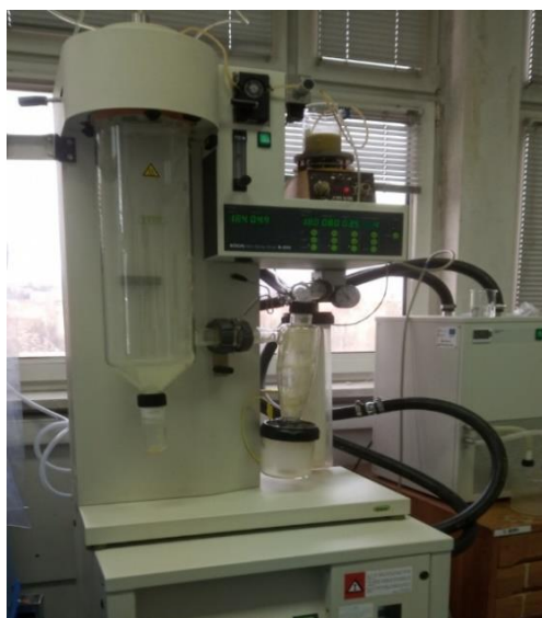
Slika 5. Uređaj za sušenje raspršivanjem (vlastita fotografija)
