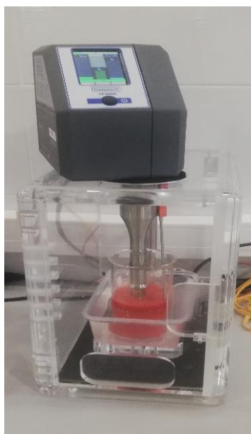
Slika 4. Tretman soka od jagode ultrazvukom visoke snage ( vlastita fotografija )
