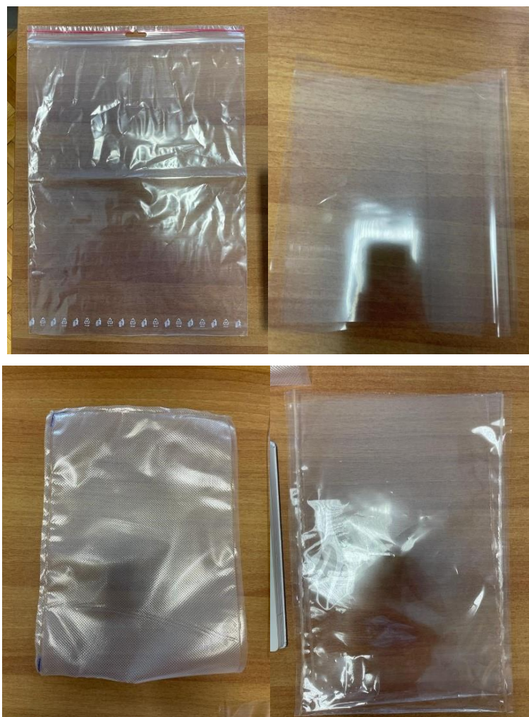
Slika 8. Polietilen niske gustoće (gore lijevo), biaksijalno orijentirani polipropilen (gore desno), poliamid/polietilen (dolje lijevo), poli(mliječna kiselina) (dolje desno) (vlastita fotografija)
