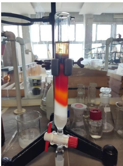
Slika 21. Kromatografija u koloni
