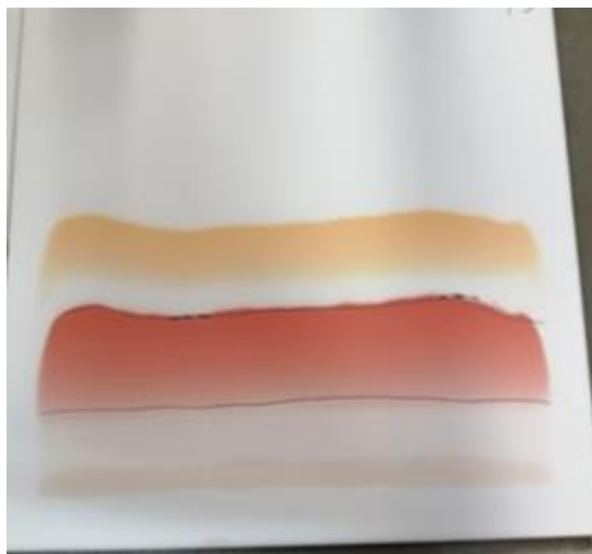
Slika 20. Preparativna tankoslojna kromatografija
