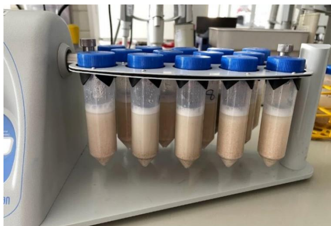
Slika 8. Uzorci nakon miješanja na „ head-over-head “ rotirajućoj miješalici
