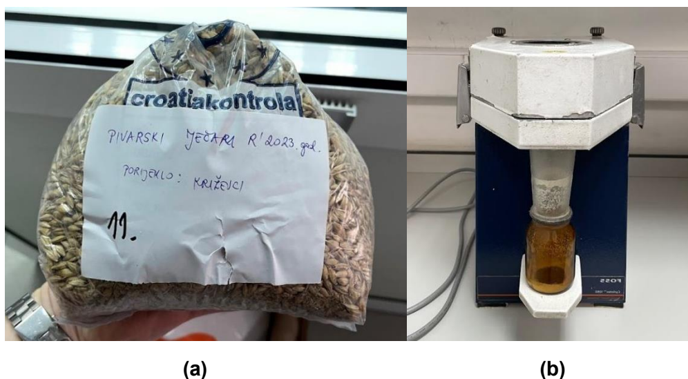
Slika 6. (a) Zrnja ječma za analizu ergot alkaloida; (b) Mlin za homogenizaciju zrnja žitarica
