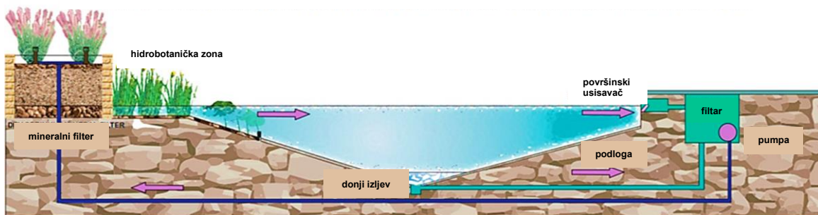
Slika 6. Biološki bazen s filtrom brzog protoka (prema Walczak i sur., 2023)
