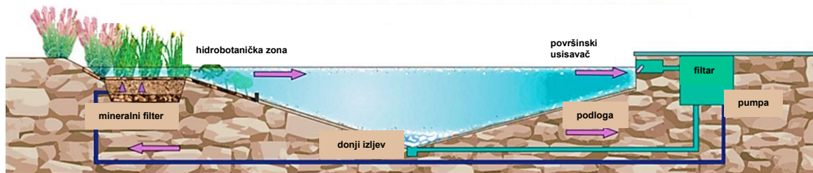
Slika 5. Biološki bazen s filtrom sporog protoka (prema Walczak i sur., 2023)
