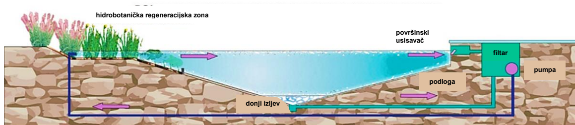
Slika 4. Biološki bazen s manjom upotrebom uređaja (prema Walczak i sur., 2023)
