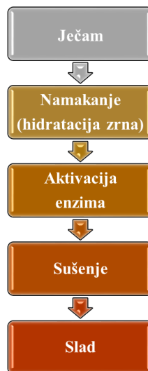
Slika 1. Tipičan proces proizvodnje slada (Stewart, 2016)
