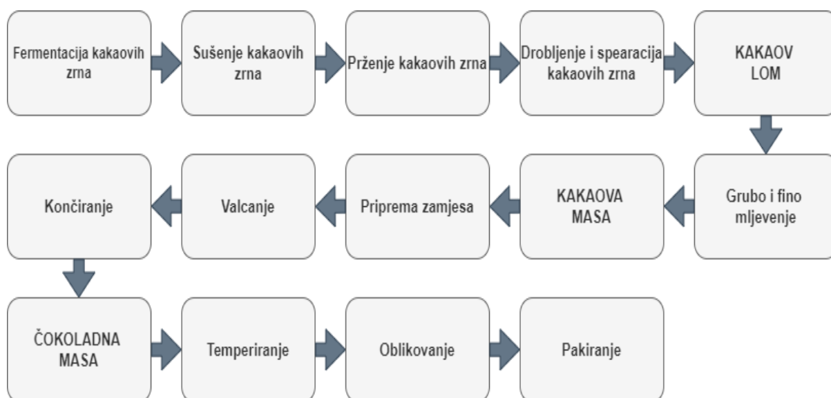
Slika 3. Postupak proizvodnje čokolade (Afoakwa, 2016)
