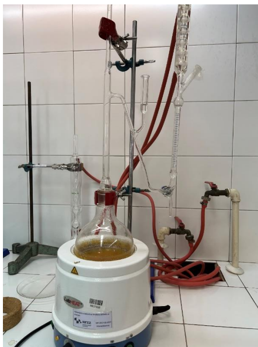
Slika 4. Aparatura za vodenu destilaciju po Clevengeru (vlastita fotografija)
