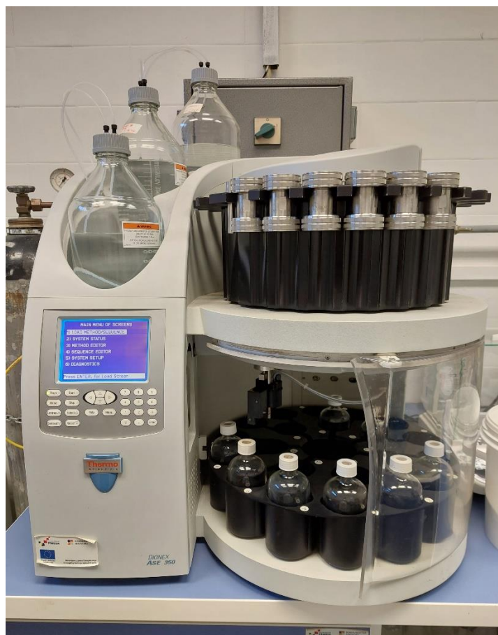
Slika 6. Ekstaktor Thermo Scientific™ Dionex™ ASE™ 350 (vlastita fotografija, 2024)
