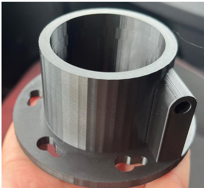
Slika 13. Protočni reaktor nakon završenog procesa 3D – ispisa (vlastita fotografija)
