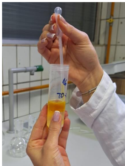
Slika 5. a) kvantitativno odvajanje gornje organske faze pipetom; b) odvojena organska faza u tikvicama (vlastita fotografija)
