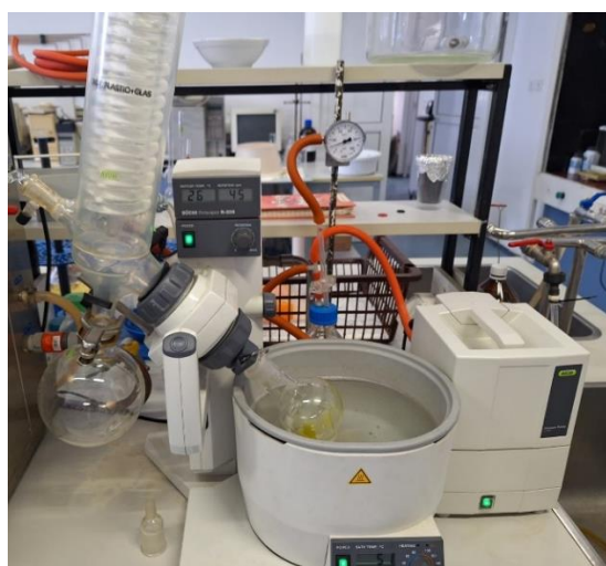
Slika 6. Otparivanje otapala pomoću rotavapora (vlastita fotografija)
