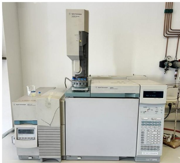
Slika 8. Analiza metilnih estera masnih kiselina na plinskom kromatografu (vlastita fotografija)
