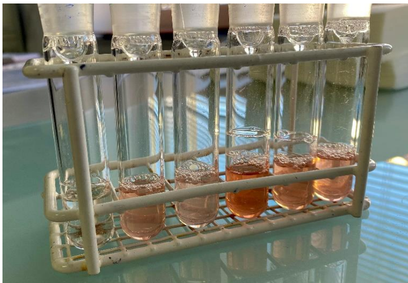
Slika 4. Razvijanje boje uzorka prilikom određivanja sadržaja L-glutaminske kiseline ( vlastita fotografija )
