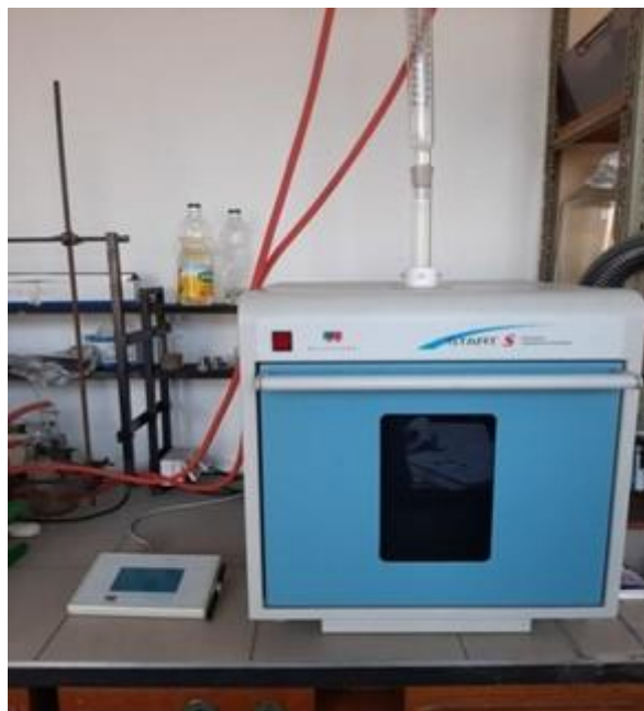
Slika 9. Mikrovalni reaktor Milestone Start S (vlastita fotografija).
