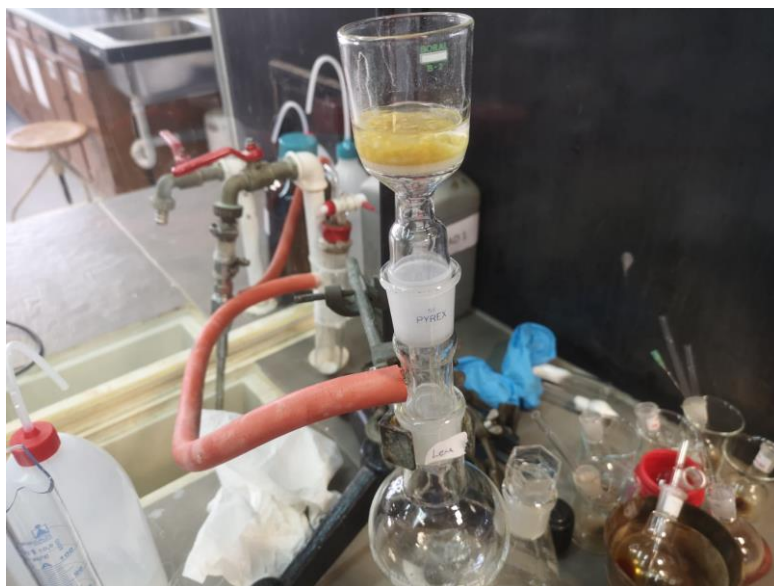
Slika 8. Sinterov lijevak s uzorkom 3 (vlastita fotografija)
