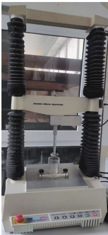
Slika 2. Texture Analyser TA.HD.plus (vlastita fotografija)
