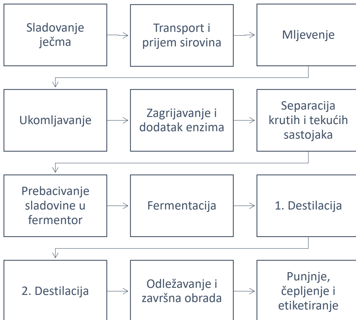
Slika 3. Dijagram tijeka tehnološkog procesa proizvodnje single malt viskija (vlastita shema)
