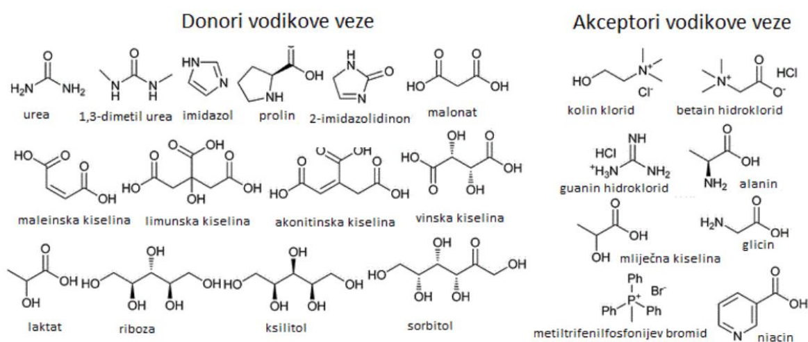
Slika 6. Kemijska struktura različitih spojeva koji se mogu koristiti za pripremu DES-ova (prema Paiva i sur., 2014)
