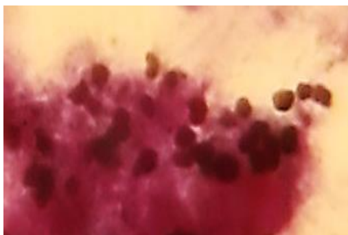
Slika 30. Aktivni mulj obojan po Neisseru za dokazivanja poliP, povećanje 400x
