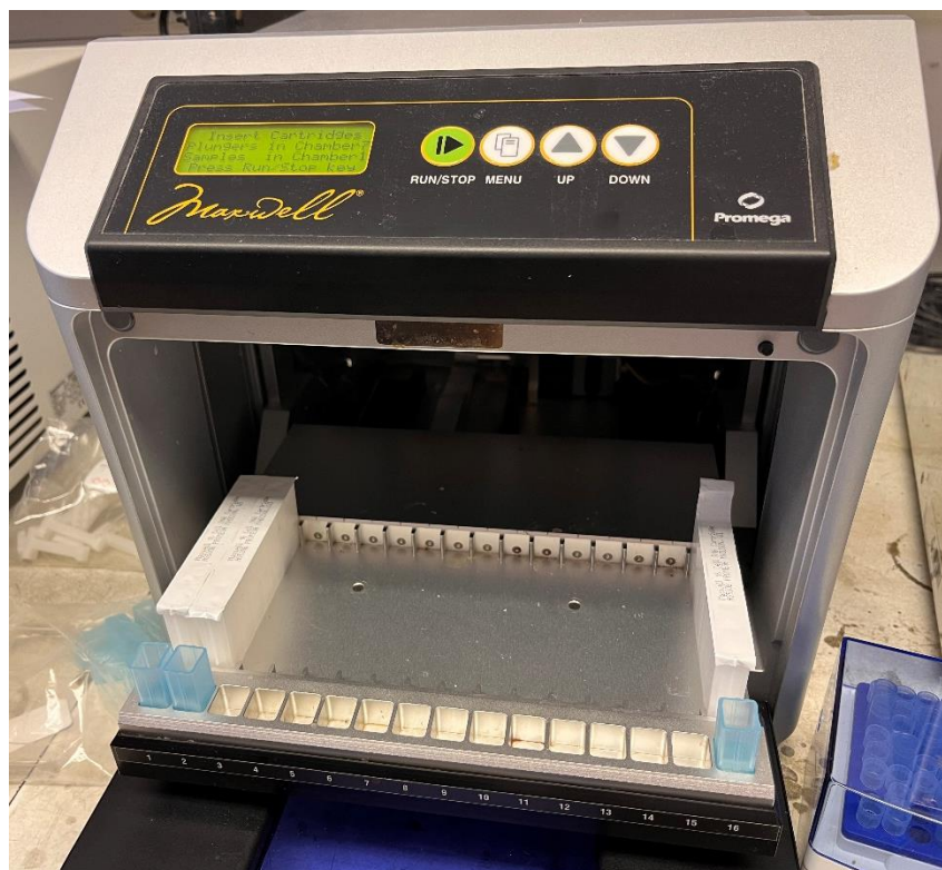
Slika 4. Maxwell 16 Research Sistemski uređaj za automatsku izolaciju DNA u koji su umetnute kazetne jažice s uzorcima
