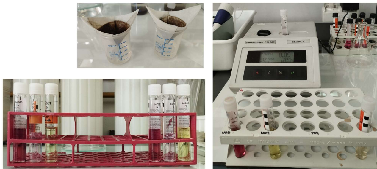
Slika 8. Filtracija uzorka za analizu KPK, NO 3 -N, NO 2 -N i PO 4 -P
