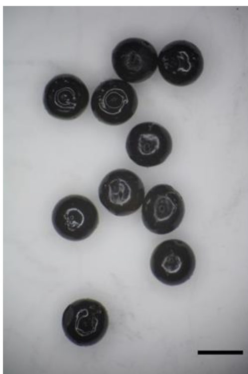
Slika 10. Optička mikrografija čestica alginatnog gela dobivenog umrežavanjem vodene otopine natrijeva alginata, w(\text{Na-alginat}) = 1,0 \% , ionima [\text{Fe}_3\text{O}(\text{CH}_3\text{COO})_6(\text{H}_2\text{O})_3]^+ . Oznaka na slici odgovara duljini od 1 mm.
