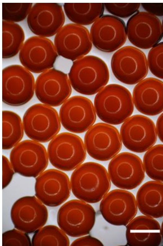
Slika 11. Optička mikrografija kuglica alginatnog gela umreženog ionima [\text{Fe}_3\text{O}(\text{CH}_3\text{COO})_6(\text{H}_2\text{O})_3]^+ , neposredno nakon sinteze. Oznaka na slici: 2 mm.
