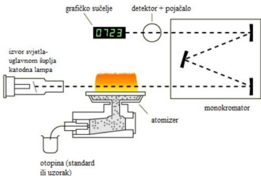
Slika 1. Shematski prikaz rada atomskog apsorpcijskog spektrofotometra (Anonymus, 2014)
