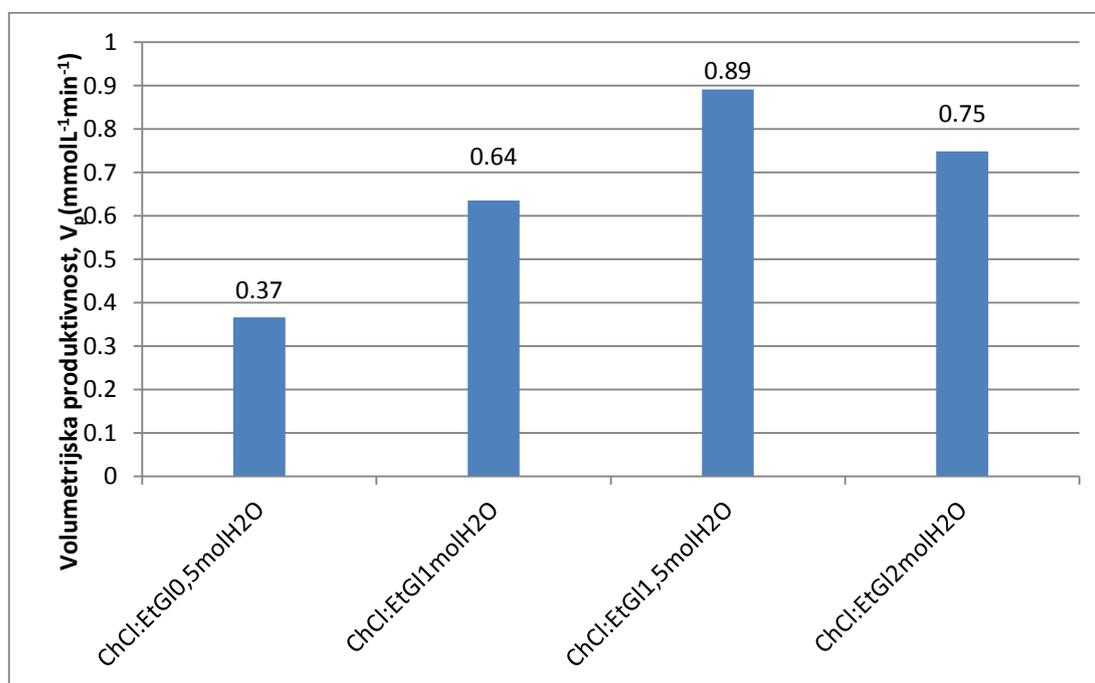
**Slika 9.** Volumetrijska produktivnost ( $V_p$ ) esterifikacije lipazom katalizirane sinteze butil-acetata u eutektičnom otapalu kolin-klorid:etilen-glikol (ChCl:EtG) uz različite molarne udjele vode (0,5 mol, 1 mol, 1,5 mol, 2 mol). Reakcijski uvjeti:  $0,05 \text{ mol L}^{-1}$  anhidrid octene kiseline;  $0,1 \text{ mol L}^{-1}$  *n*-butanola; 5 mg Novozym 435;  $25 \text{ }^{\circ}\text{C}$ .
