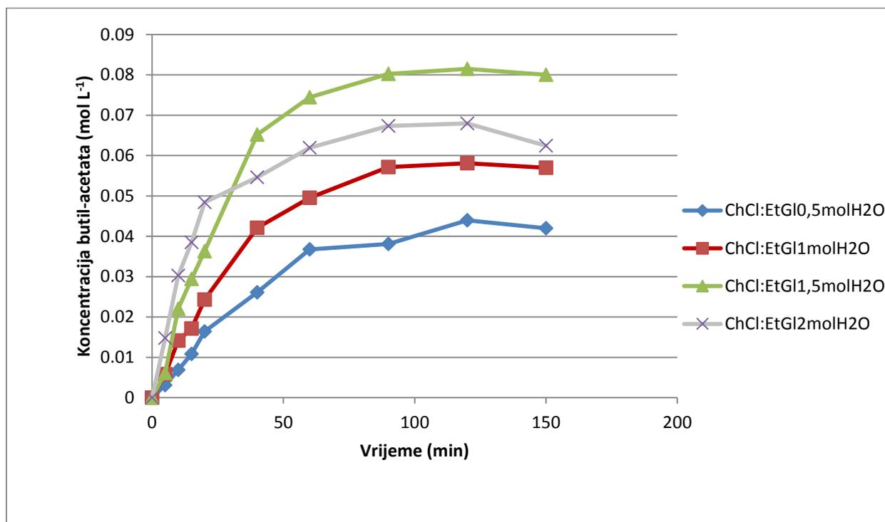
**Slika 7.** Tijek esterifikacije lipazom katalizirane sinteze butil-acetata u eutektnom otapalu kolin-klorid:etilen-glikol (ChCl:EtGl=1:2) sa određenim molarnim udjelom vode (0,5 mol, 1 mol, 1,5 mol, 2 mol).
