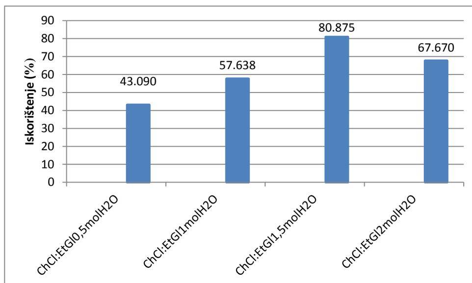
**Slika 8.** Iskorištenje ( $\eta$ ) esterifikacije lipazom katalizirane sinteze butil-acetata u eutektičnom otapalu kolin-klorid(ChCl):etilen-glikol(EtG) uz različite molarne udjele vode. Reakcijski uvjeti:  $0,05 \text{ mol L}^{-1}$  anhidrid octene kiseline;  $0,1 \text{ mol L}^{-1}$  *n*-butanola; 5 mg Novozym 435;  $25 \text{ }^{\circ}\text{C}$ .
