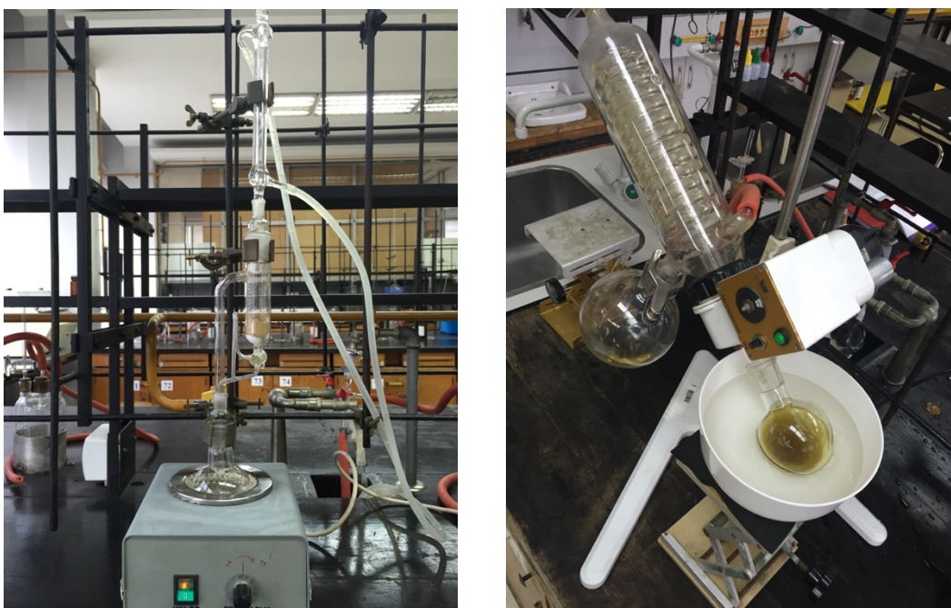
Slika 9. Aparatura za Soxhlet ekstrakciju (lijevo) i rotavapor (desno)
